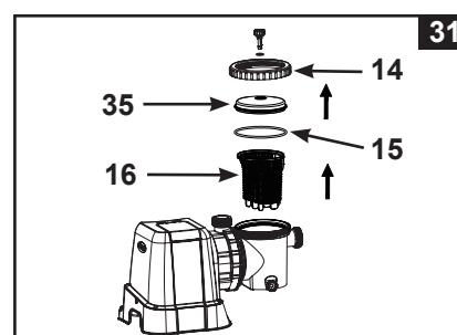
5. Vyprázdnite a prepláchnite kôš pomocou záhradnej hadice. Môžete použiť plastovú kefu na odstránenie usadenín z koša. Nepoužívajte kovovú kefu.
